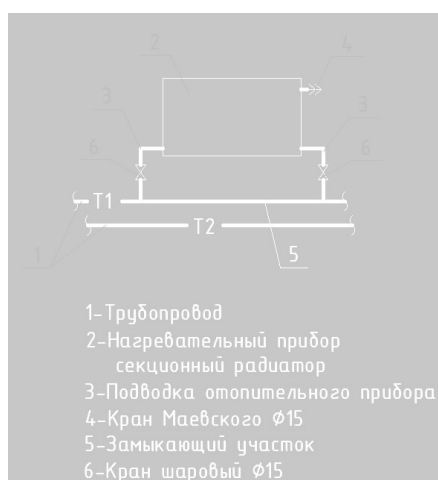
Рисунок 4 – Существующая схема присоединения нагревательного прибора
