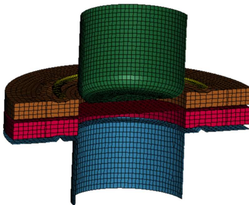
Рисунок 2 – Модель вытяжного штампа
