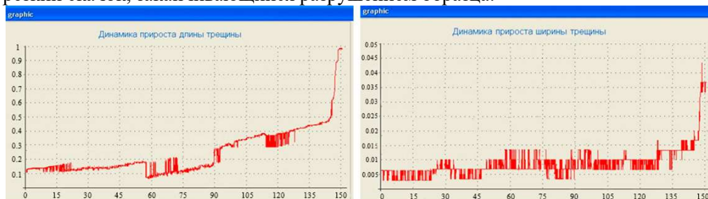
Рисунок 5 – Кинетические графики развития трещины (горизонтальная ось – время роста трещины, ч; вертикальная ось – скорость роста трещины, мм/ч)
