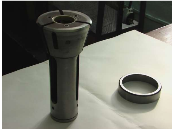
Рисунок 2 – Специальные модели нагружающих устройств и зажимов
