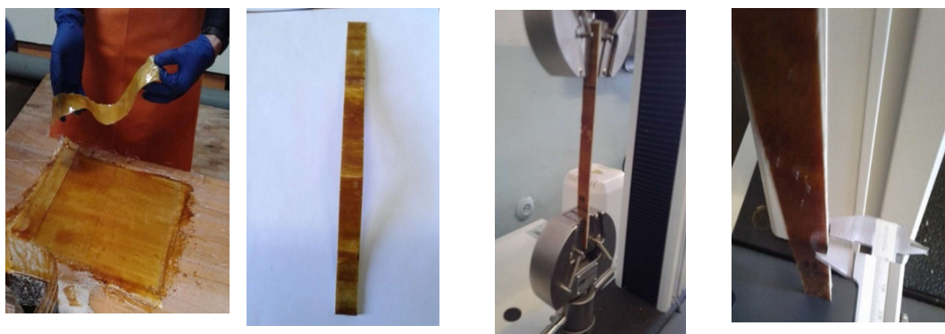
Рисунок 1 – Изготовление и подготовка образцов к проведению экспериментов
