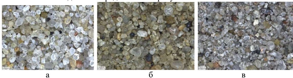
Рисунок 1: а – песок морской (ПМ), б – песок карьер пос. Синявино (ПС), в – песок карьер Рыбачье (ПР)
