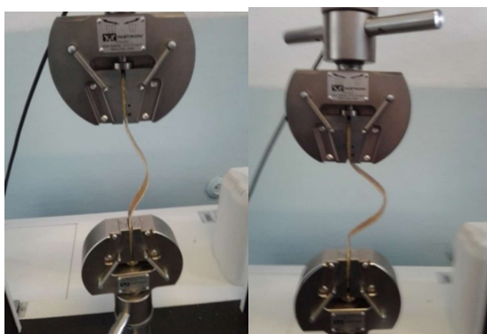
Рисунок 3 – Испытание на сжатие двуслойных пластин
