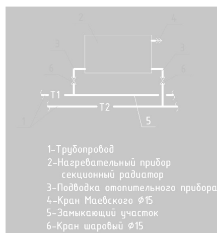
Рисунок 5 – Предлагаемая схема присоединения нагревательного прибора
