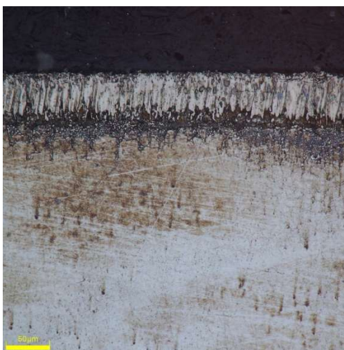
Рисунок 1 – Микроструктура диффузионного боридного слоя с переходной зоной. t=950 0 С; τ=1 час; толщина боридного слоя = 70 мкм
