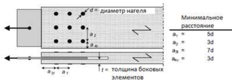
Рисунок 5 – Схема расстановки нагелей
